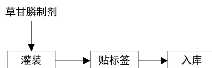
图 2-4 200L 包装线工艺流程图
